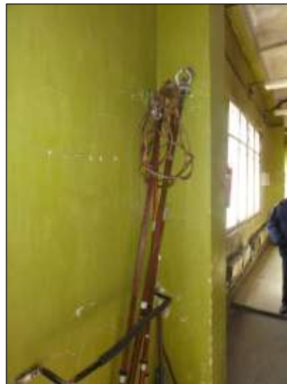
Լուսանկար 4-5՝ Անվտանգության սարքավորումներ և գործիքներ բարձր լարման տակ աշխատելու համար Աշնակի ենթակայանում
