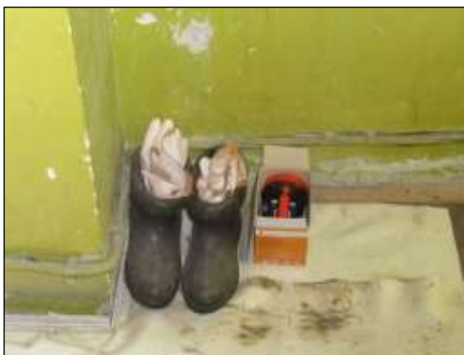
Լուսանկար 4-5՝ Անվտանգության սարքավորումներ և գործիքներ բարձր լարման տակ աշխատելու համար Աշնակի ենթակայանում
