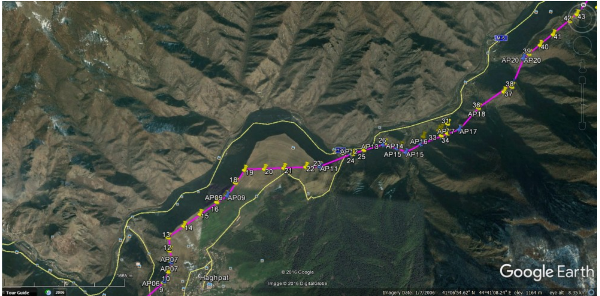
Նկ. 4. Լալվար և Նոյեմբերյան ՕԳ-երի տեղադիրքը Google Eart ծրագրի էջում, Նեղոց – Հաղպատ հատվածը/30- 34 հենարանների օգնությամբ Լալվարև Նոյեմբերյան օղային գծերը միանում են „Ախթալա-2,, ենթակայանին/
